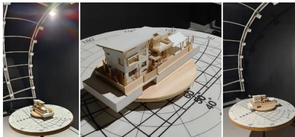
ภาพที่ 7 การใช้หุ่นจำลองทดลองการโคจรของดวงอาทิตย์ผ่านเครื่องจำลองแสงอาทิตย์ (Solar Simulators)
